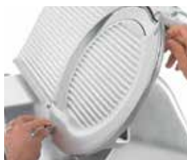
Prática desmontagem do protetor da lâmina.
